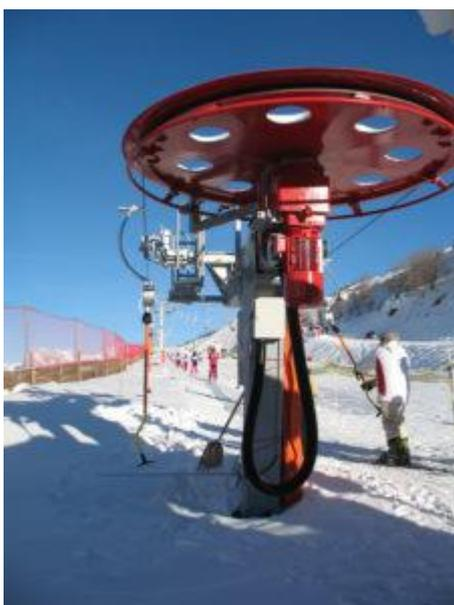
**LA** : Поверхностный лифт LA - идеальный выбор для более длинных, более крутых линий. Компактная стационарная приводная станция до 200 кВт без возврата противовеса. Эта модель доступна только с бугелями Т – образного типа.
