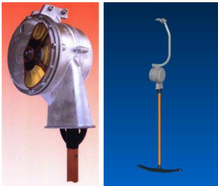
Проверенный и проверенный LST 260 Hydro пружинный бокс с гидродинамическим тормозом обеспечивает прогрессивный запуск лыжников и сноубордистов, что является настоящим бонусом для новичков.
