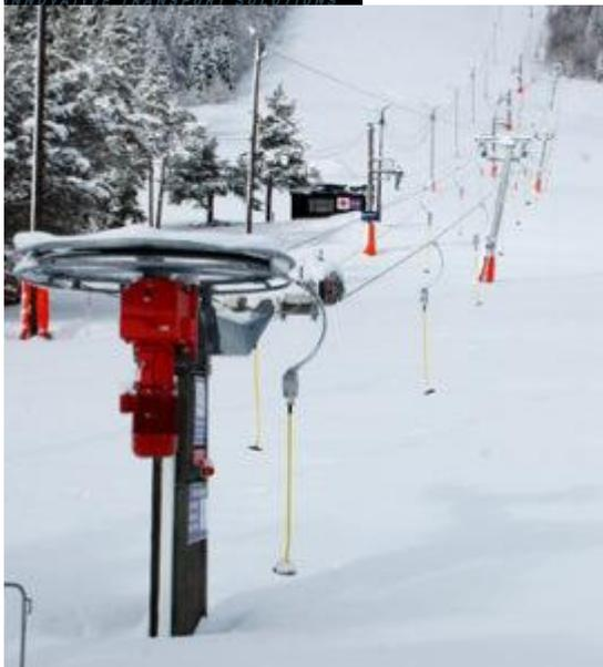
**Hydro 470 & Hydro 550** : Благодаря электрически управляемой гидравлической системе натяжения компактный гидропривод и станция натяжения в сочетании с фиксированным возвратом без обслуживания являются идеальной комбинацией для всех требований высоты подъема поверхности до 75 кВт. Эта модель доступна только с бугелями Т – образного типа.
