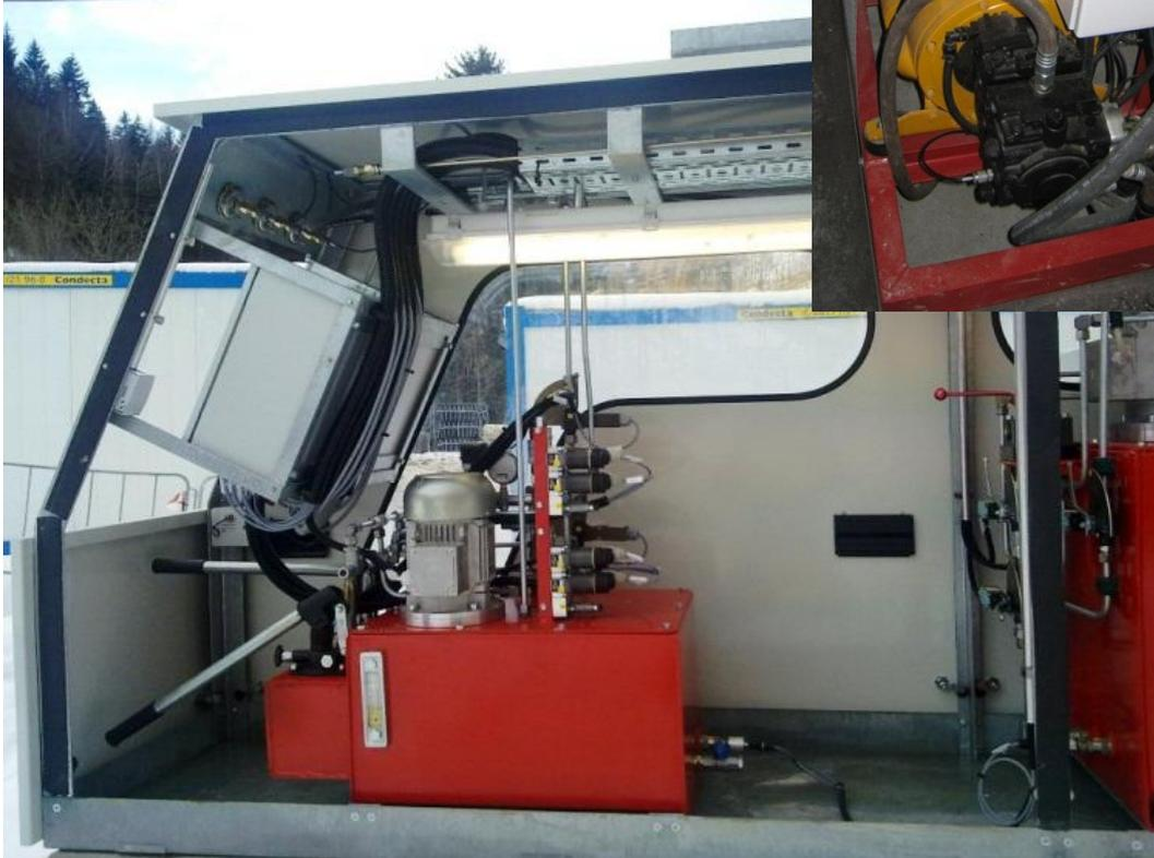
*Гидравлический механизм торможения и натяжения*
