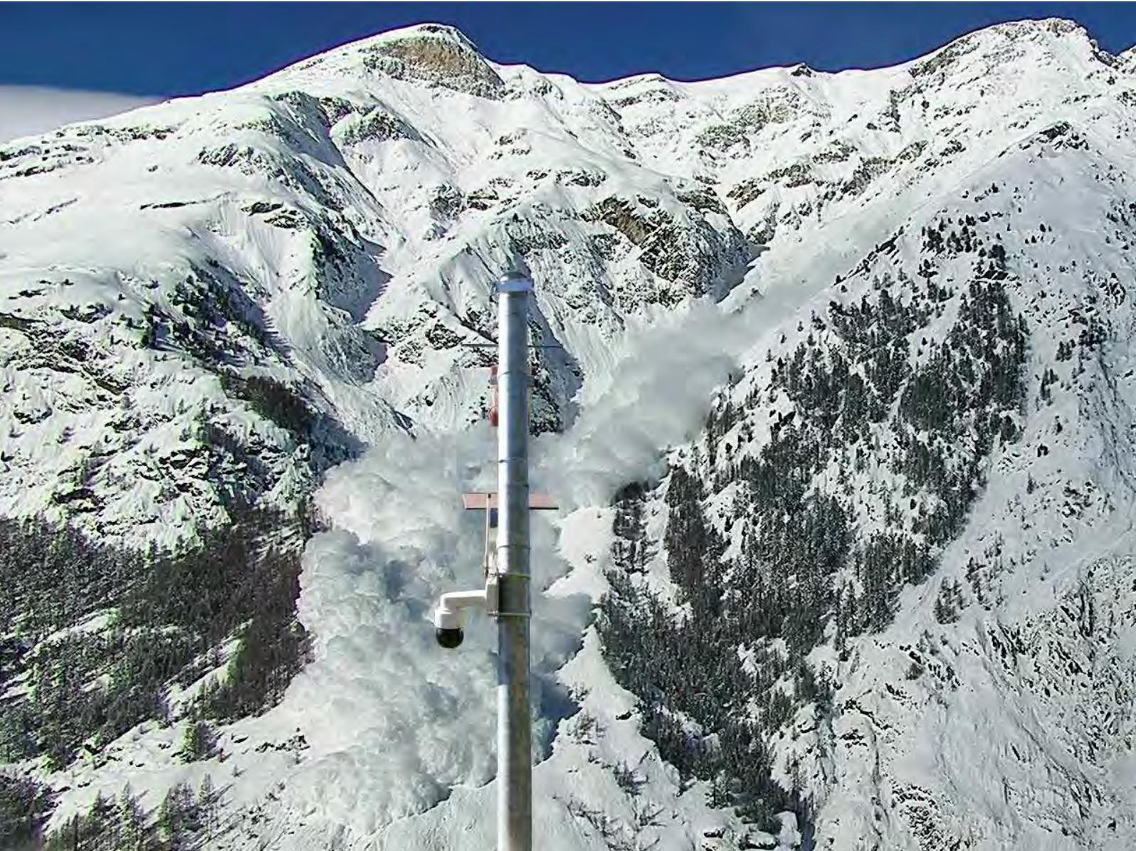
Автоматическое обнаружение лавины с использованием радиолокационной техники всепогодное и в любое время суток. Обнаружение в режиме реального времени с параметром тревоги для автоматического управления трафиком. Надежные результаты обнаружения с диапазоном до 4 км, и онлайн-визуализация лавинных треков.
