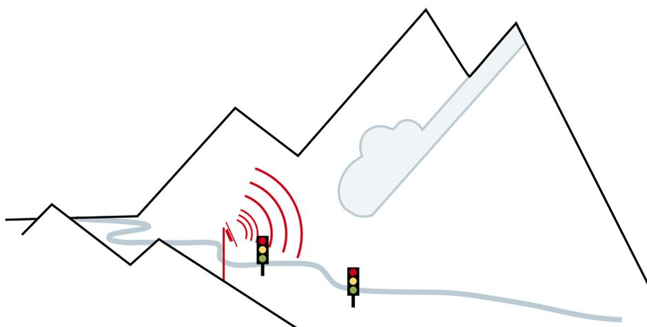
Рисунок 1: Лавинный радиолокатор отслеживает лавинные склоны с противоположной стороны долины. Он непрерывно сканирует склон для лавин, независимо от погоды или времени суток. Обнаруженные лавины отслеживаются и иллюстрируются в онлайн-портале данных. Если они связаны с системой сигнализации, дороги автоматически закрываются в течение нескольких секунд.
